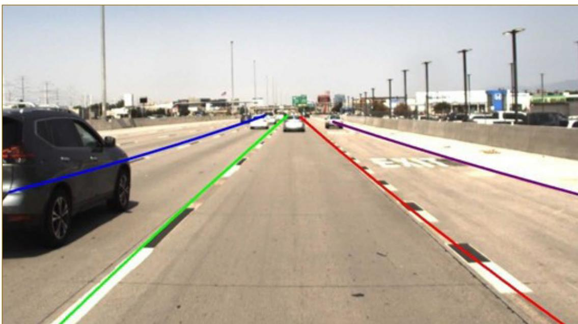
**Figure 5.4** – Les Contrast lane markers augmentent la fiabilité des systèmes LKA (*Lane Keeping Assistance*) et LDW (*Lane Departure Warning*), en particulier sur les revêtements de couleur claire et par forte luminosité (*VSI Labs, 2021*)
