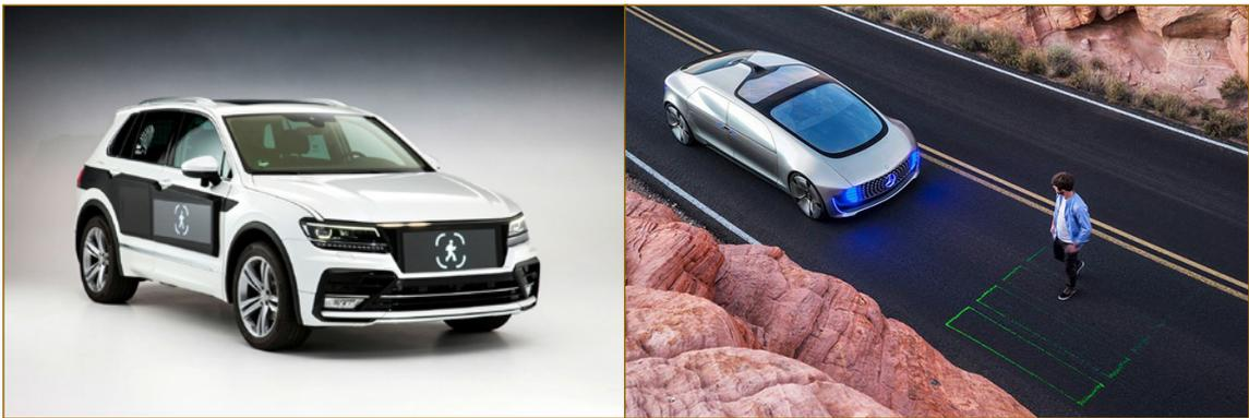
**Figure 5.10** – Exemple d'un véhicule équipé de plusieurs écrans d'information pour communiquer avec les piétons (Volkswagen Tiguan) – projection d'un passage pour piétons (Duff, 2015 ; *Light staging and exterior HMI*, 2018)
