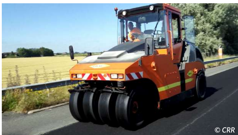
Figure 6.38 – Compacteur avec système de pulvérisation pour maintenir les pneus humides
