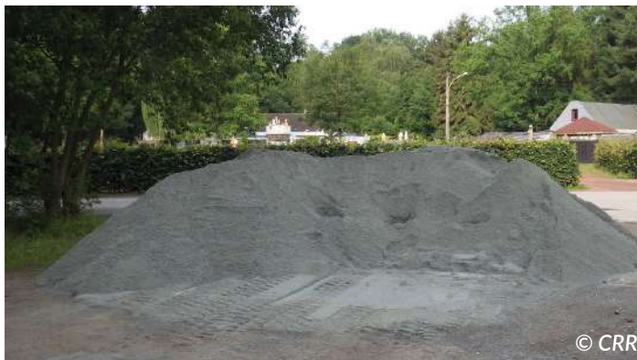
Figure 6.2 – Stock de granulats prélevés à quelques centimètres au-dessus de la surface au sol
