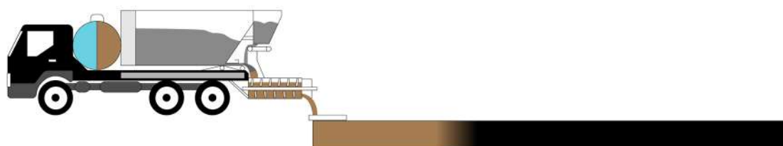
Figure 6.18 – Illustration de la machine à MBCF et du principe d'épandage du MBCF
