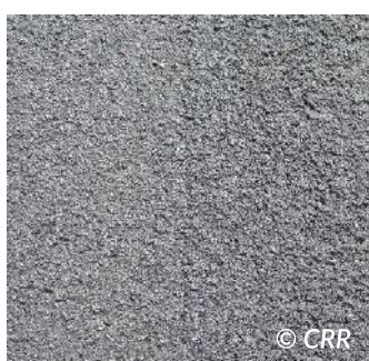
Figure 1.2 - Texture rugueuse d'un MBCF lors de la mise en œuvre
