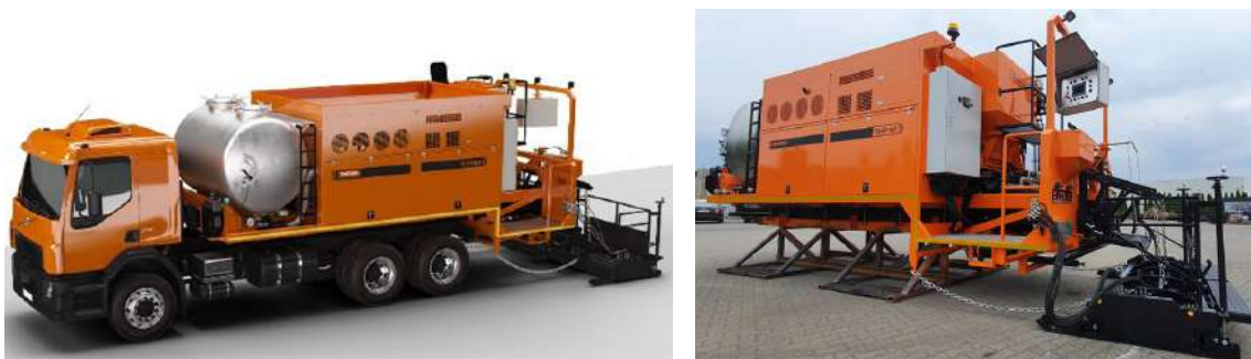
Figure 6.9 – Machine à MBCF sans et avec le châssis de camion (Source: Strassmayr)
