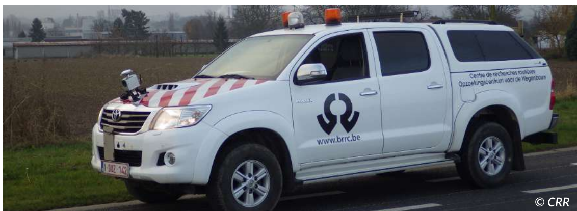
Figure 7.6 – Véhicule de mesure CRR équipé de l'Imajbox®
