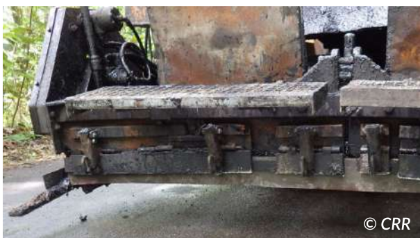
Figure 6.22 – Bavette en caoutchouc
