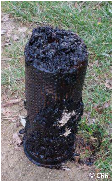
Figure 6.8 – Filtre à émulsion sale de la machine à MBCF
