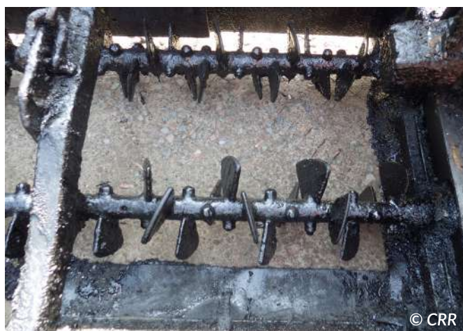
Figure 6.15 – Mécanisme de mélange dans le traîneau
