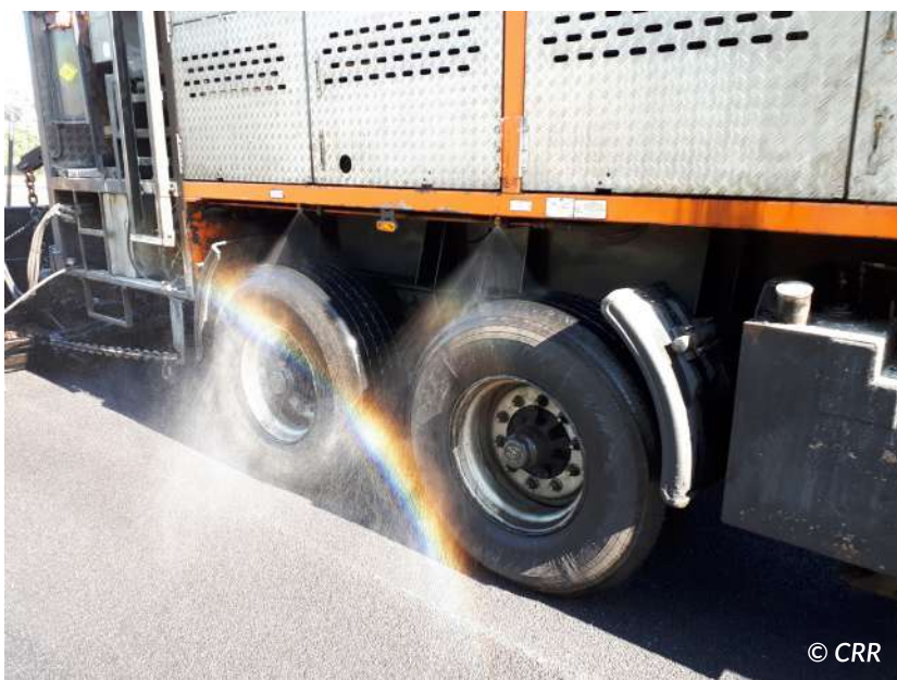
Figure 6.27 – Camion équipé d'un système de pulvérisation pour les pneus
