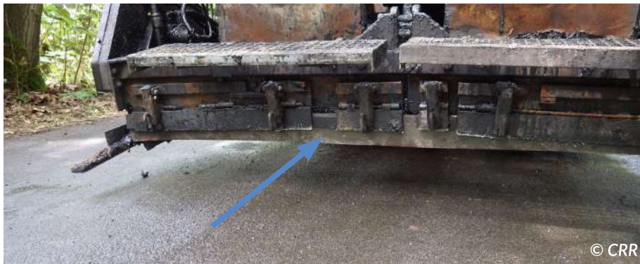
Figure 6.16 – Traîneau avec bavette flexible en caoutchouc
