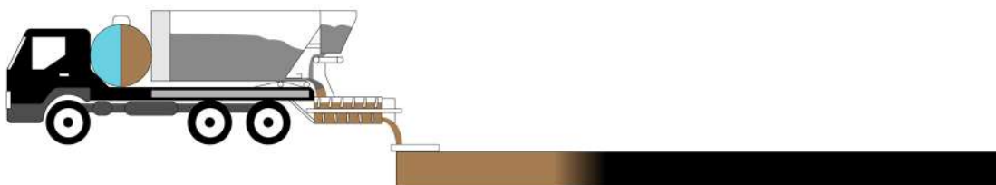
Figuur 6.18 – Afbeelding van de slemmachine en het spreidingsprincipe van de slem
