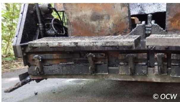
Figuur 6.22 – Elastische afwerkslab
