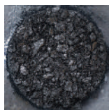
Figuur 5.5 – Voorbeeld van uitvoering van de cohesieproef volgens norm EN 12274-4 (NBN, 2018b)
