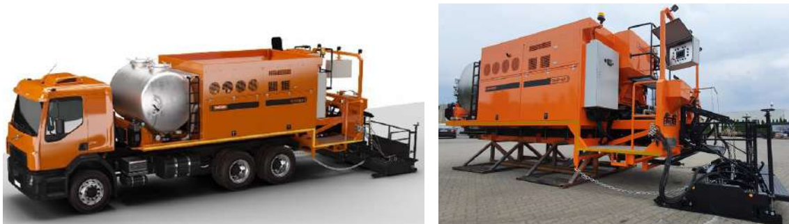
Figuur 6.9 – Slemmachine zonder en met vrachtwagenchassis (bron: Strassmayr)
