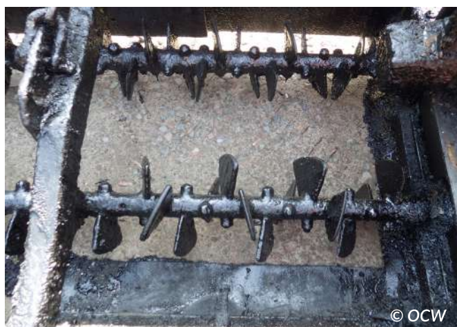
Figuur 6.15 – Mengmechanisme in de slede
