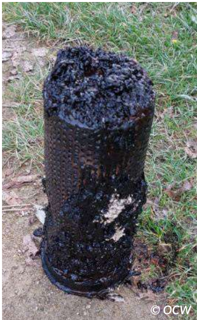
Figuur 6.8 – Vervuilde emulsiefilter van slemmachine
