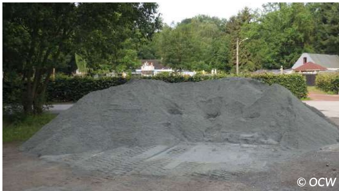
Figuur 6.2 – Stock van aggregaten die enkele centimeters boven het oppervlak werd ingeschept
