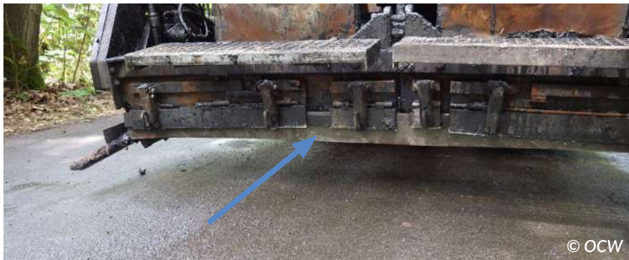
Figuur 6.16 – Slemslede met flexibele afstrijkslab
