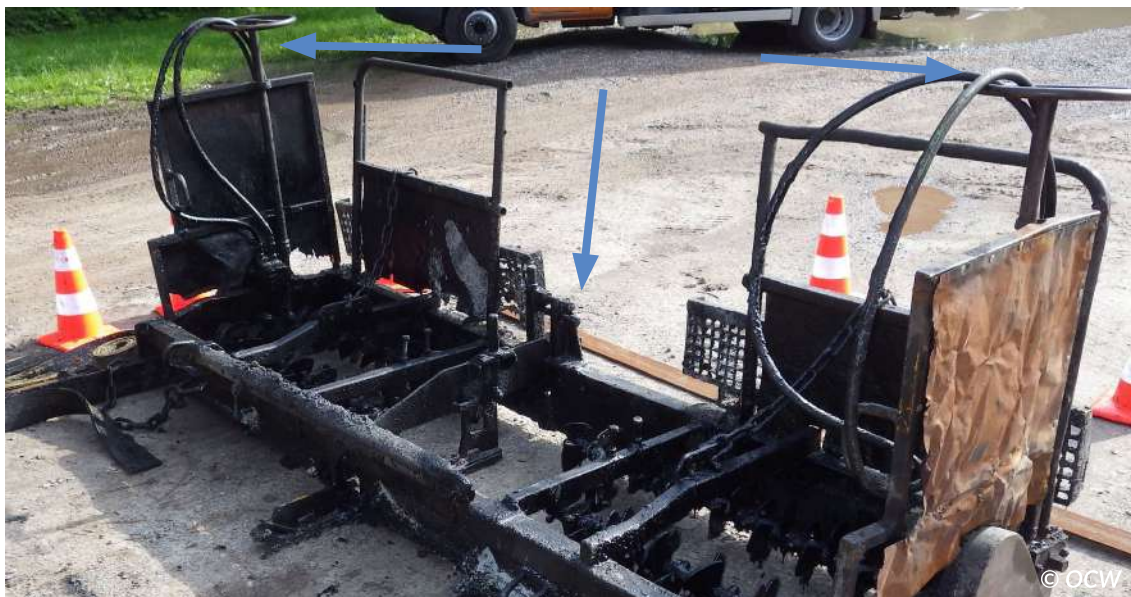
Figuur 6.13 – Slede met twee instelwielen op de zijkanten en centraal een derde instellingspunt om de hoogte te regelen
