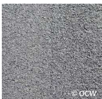
Figuur 1.2 – Ruwe textuur van een slem bij plaatsing
