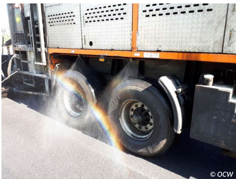
Figuur 6.27 – Vrachtwagen uitgerust met sproeisysteem voor de banden
