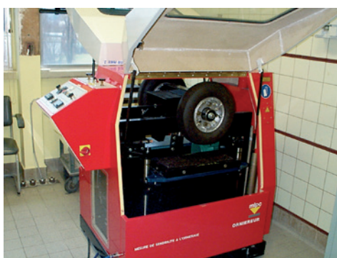
Figure 3.4 – Simulateur de trafic
