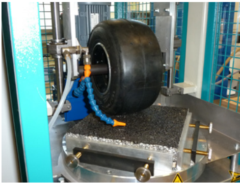
Figure 3.5 – Dispositif pour l'essai de plumage (DSD ou Darmstadt Scuffing Device)
