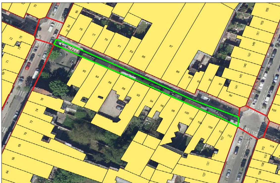
Figuur 1.10 – Voorbeeld van opdeling in wegvakonderdelen met behulp van veelhoeken
