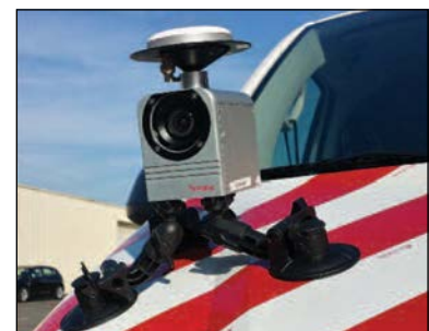
Figuur 1.23 – Meetvoertuig met IMAJBOX®
