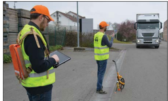
Figuur 1.16 – Visuele inspectie te voet met behulp van een tablet
