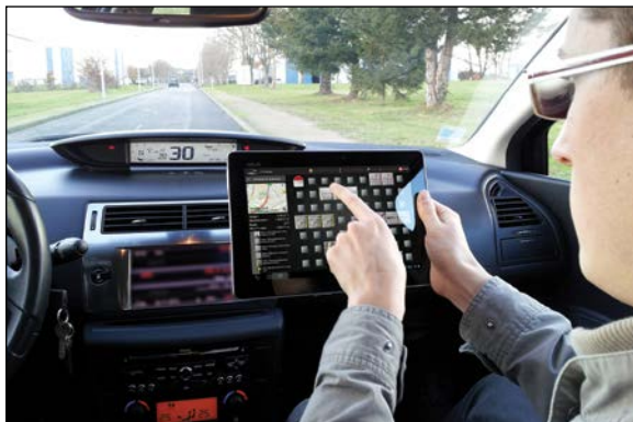
Figuur 1.21 – “L2R Mesure”: schaderegistratie met een tablet in een voertuig (bron: Logiroad)
