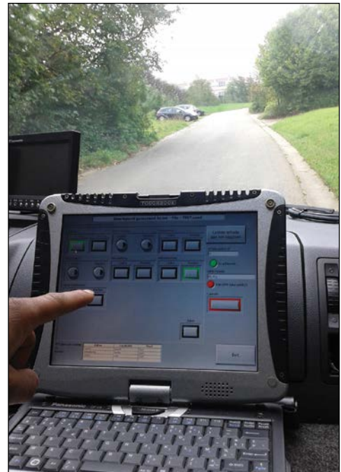
Figuur 1.20 – SAND: draagbare pc met aanraakscherm voor schaderegistratie
