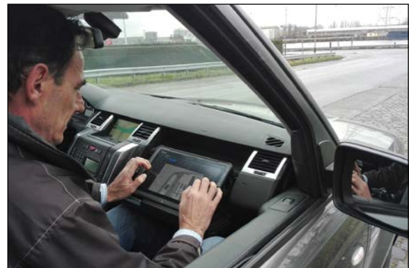
Figuur 1.22 – Arch & Tecotablet: schaderegistratie met een tablet in een voertuig (bron: Arch & Teco)
