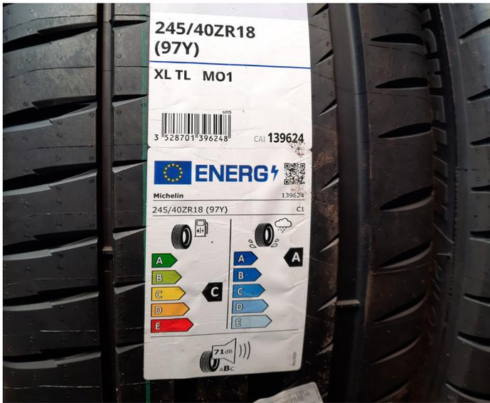
**Figure 1** – L'étiquette européenne pour les pneumatiques telle qu'introduite par le règlement 2020/740/UE
