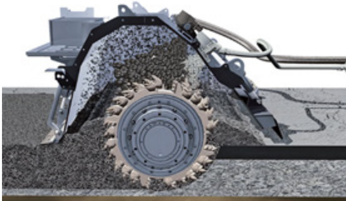
Figure 4 – Coupe transversale rouleau de fraisage et unité de malaxage recycleur in situ (Source: Wirtgen)
