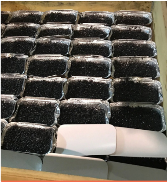
Figuur 3 – Bemonstering in de asfaltmenginstallatie: bakjes gevuld met gietasfalt
