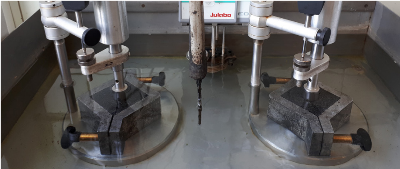
Figuur 1 – Indekingsapparaat van OCW met kubusvormige proefstukken
