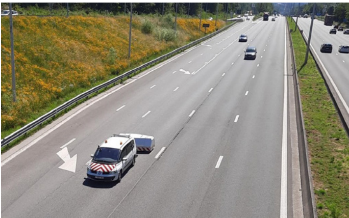
Figuur 1 – Metingen met de CPX-aanhangwagen van OCW
