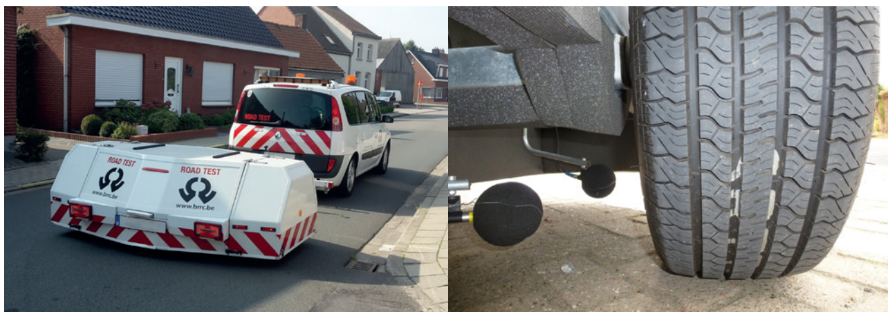
Figuur 2 – CPX-aanhangwagen van OCW (links); binnenkant van de CPX-aanhangwagen met P1-band (rechts)
