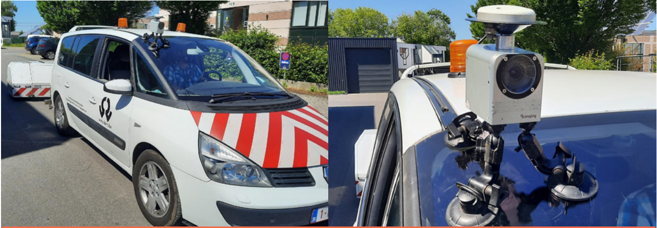
Figuur 3 – Bevestiging van de IMAJBOX® op het meetvoertuig
