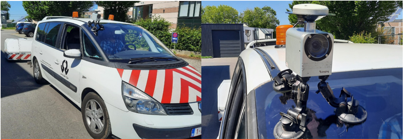
Figure 3 – Montage de l'IMAJBOX® sur le véhicule de mesure.
