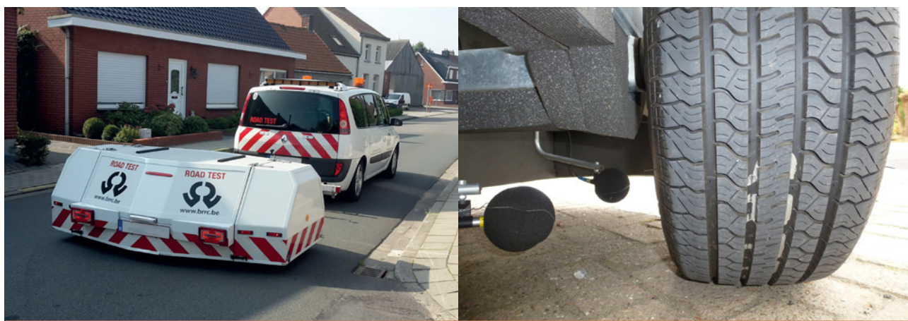
Figure 2 – Remorque CPX du CRR (à gauche); intérieur de la remorque CPX du CRR avec pneu P1 (à droite).
