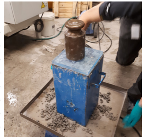
Figuur 6 – Aangepaste proeven ter bepaling van de verwerkbaarheid van poreuze betonmengsels (compo 2)
