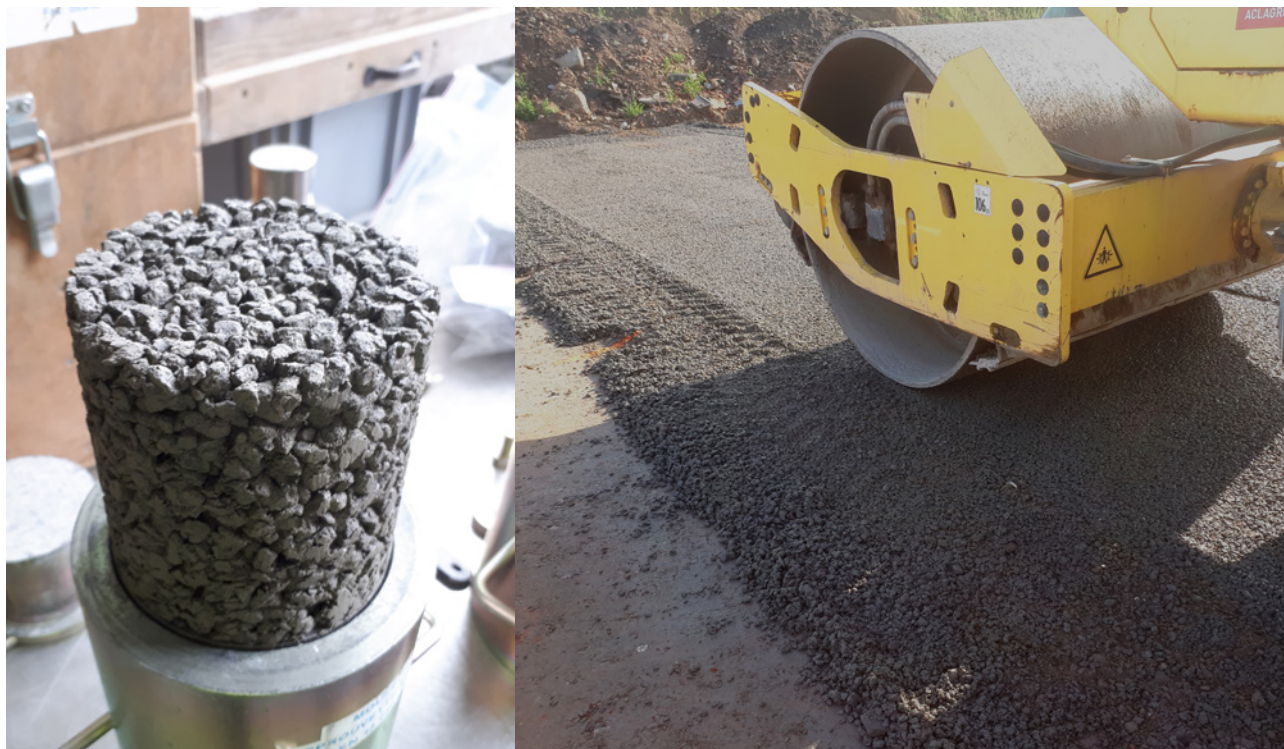
Figuur 3 – Zoektocht naar een verdichtingsmethode in het laboratorium die representatief is voor de toestand op de bouwplaats
