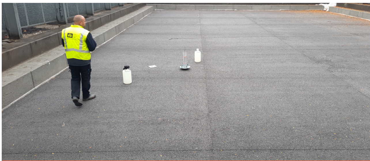
Figure 11 – Application récente de béton drainant sur un terrain de basket-ball à Borgerhout, suivi effectué par le CRR
