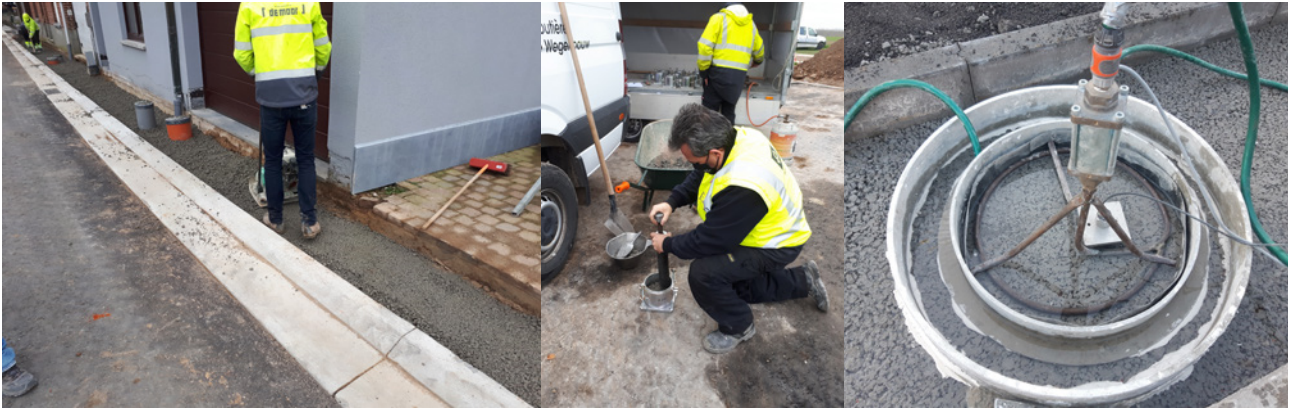
Figure 9 – Suivi d'un chantier avec application de béton maigre drainant comme fondation sous des pavages à Herzele
