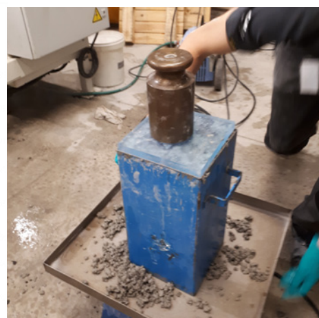
Figure 6 - Essais adaptés de détermination de la maniabilité de mélanges en béton poreux (composition 2)
