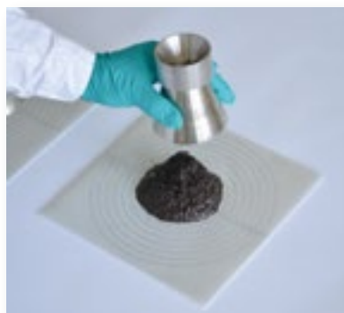
Proef voor consistentie volgens NBN EN 12274-3
