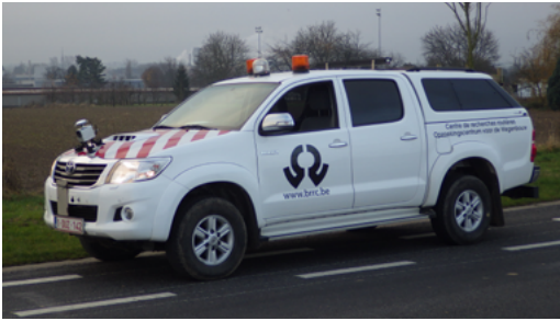
Figuur 1 – OCW-meetvoertuig uitgerust met Imajbox®
