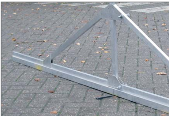
Figure 4.5 Mesure des inégalités à l'aide d'une règle de 3 m
