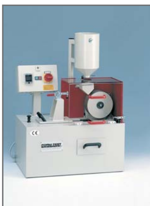
Figure 3.4 Appareil Capon et éprouvette testée
