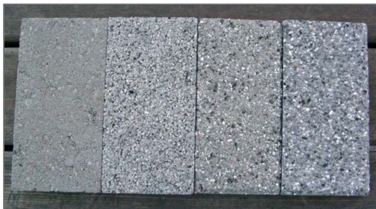
Figure 1.49 Surface supérieure du pavé non traitée, dénudée, grenillée et bouchardée
