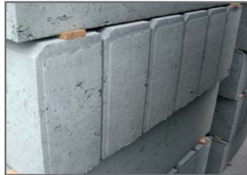
Figure 4.3 Face supérieure anti-éclats d'un contrebutage
