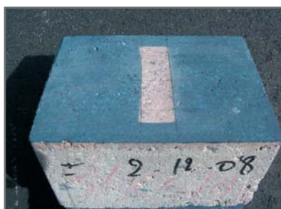
Figure 3.4 Appareil Capon et éprouvette testée
