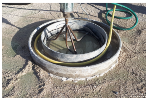
Figuur 2 – Dubbele-ringproef van OCW
