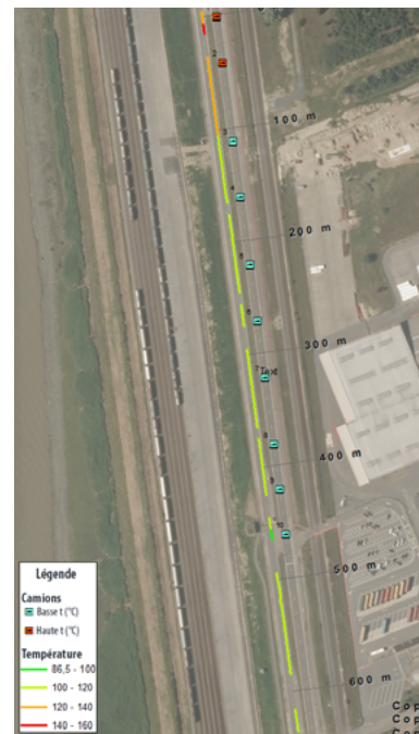
Mesure de la température de l'enrobé lors de travaux d'entretien au port d'Anvers
