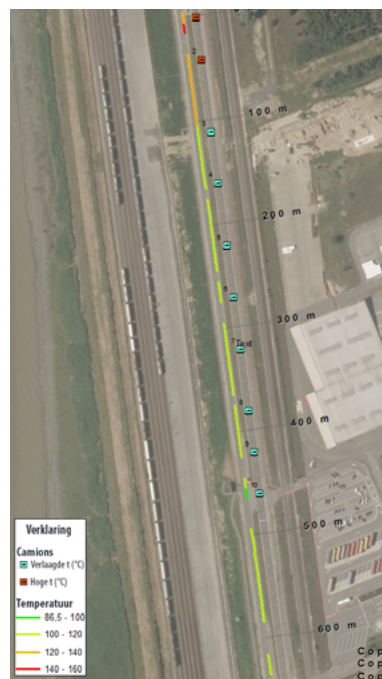
Meting van de temperatuur van asfalt tijdens onderhoudswerkzaamheden in de haven van Antwerpen
