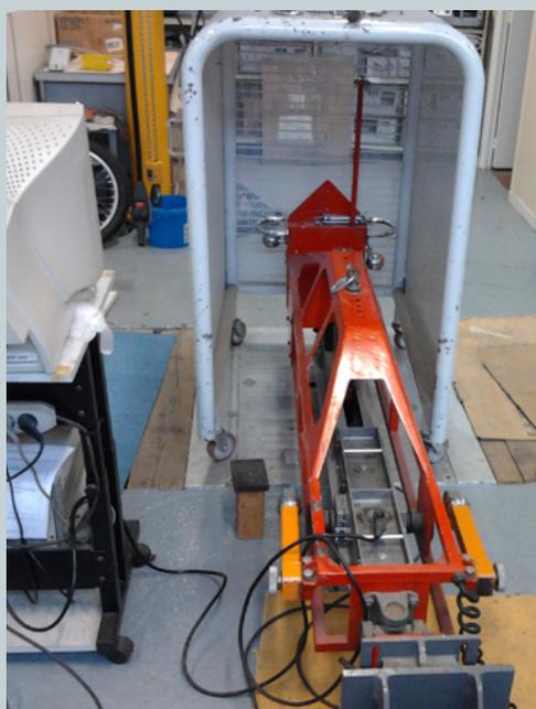
**Figure 6** – Calibration des remorques APL du CRR
