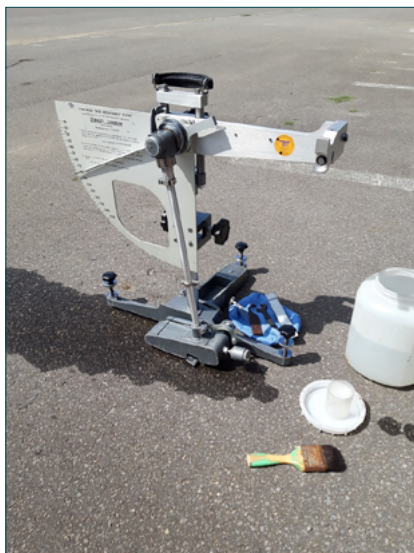
Figuur 1 – De SRT-slinger
