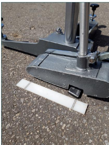
Figure 3 – Mesure d'une longueur de 126 mm
