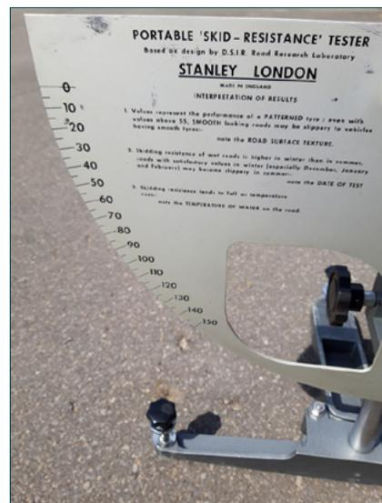
Figure 4 – Echelle arbitraire du pendule SRT (Pendulum Test Value, PTV)
