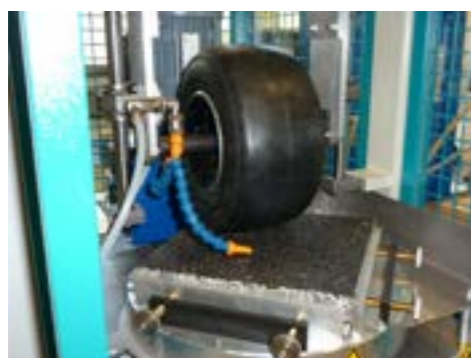
Figuur 3.5 – Rafelingsproefopstelling (DSD of Darmstadt Scuffing Device)
