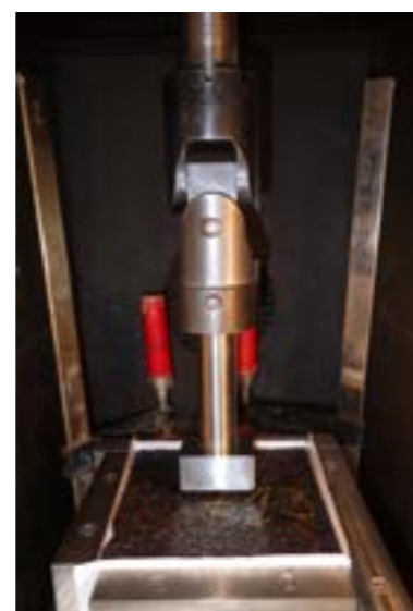
Figuur 3.8 – Opstelling statische drukproef voor containerterminals
