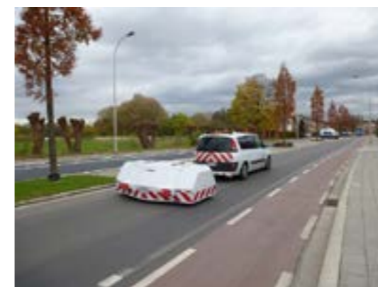
Figuur 3.10 - De CPX-aanhangwagen van OCW
