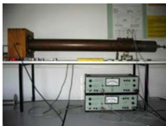
Figuur 3.11 – Kundt-tube gebaseerd op transfermethode
