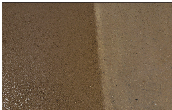
Figuur 2.6 – Tijdens het afkoelingsproces kan een kleurwijziging in het asfalt optreden (links: kleur bij 50 °C; rechts: kleur bij 35 °C)
