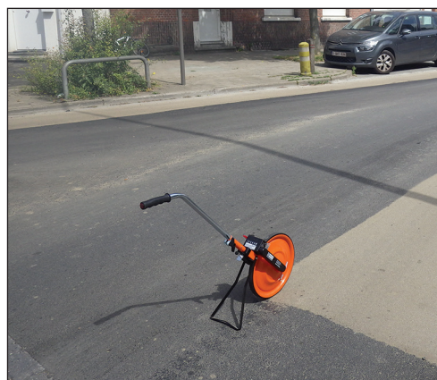
Figuur 2.1 – Hodometer om de grootte van de bouwplaats te meten en de afstanden voor de uitvoering van kleurmetingen te bepalen
