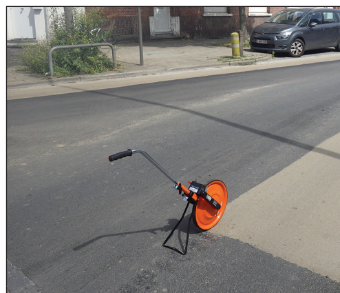
Figure 2.1 – Illustration d'un odomètre pour mesurer l'étendue du chantier et les distances pour la réalisation des mesures de couleur
