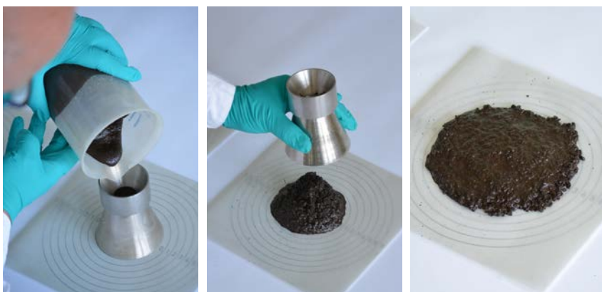
Figure 2 – Essai de consistance selon la NBN EN 12274-3
