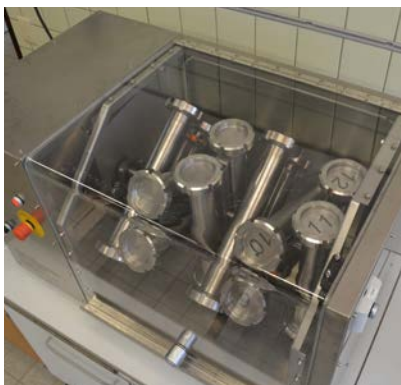
Figure 5 – Essai d'abrasion par agitation selon la NBN EN12274-7
