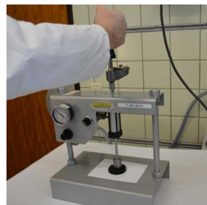
Figure 3 – Essai de cohésion selon la NBN EN 12274-4
