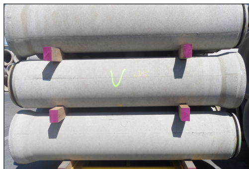
Figuur 2.2 – Op stalen palet (links) en houten balken (rechts) gestapelde betonbuizen (Bron: Lithobeton)
