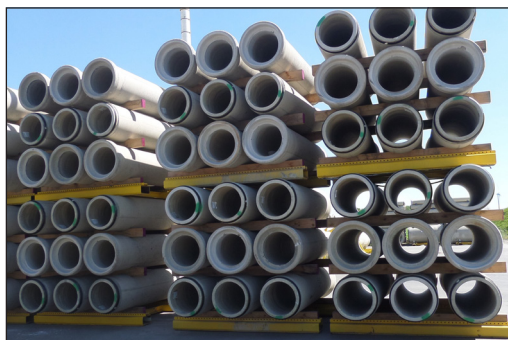
Figuur 2.2 – Op stalen palet (links) en houten balken (rechts) gestapelde betonbuizen (Bron: Lithobeton)
