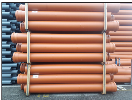
Figuur 2.31 – Stapelen van kunststofbuizen in bundel (Bron: Kurio)
