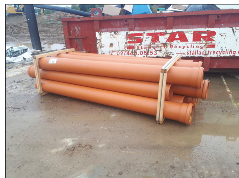
Figuur 2.14 – Met spanbanden en houten balken samengehouden bundel kunststofbuizen (Bron: Kurio)
