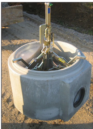
Figuur 2.19 – Hijstangen op een inspectieput (Bron: Nemacor Nederland)
