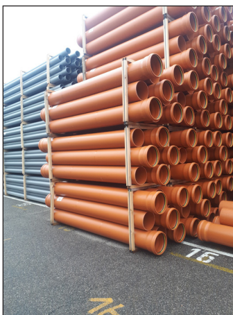
Figuur 2.4 – Met houten latten of balken gebundelde kunststofbuizen en samen gehouden met spanband (Bron: Kurio)
