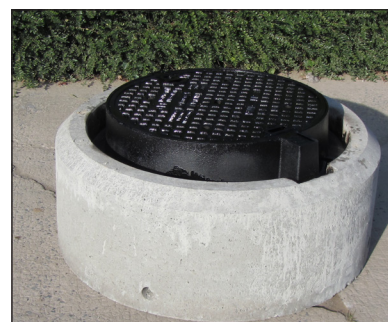
Figuur 8.18 – Traploos in hoogte regelbaar putdeksel van het type 5 met rond kader van nodulair gietijzer in geprefabriceerde betonnen onderrand (Bron: BNK/Riooldeksel.be)
