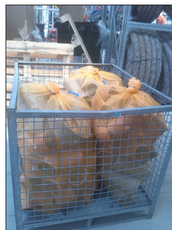
Figuur 2.25 – Stapelen van kunststofhulpstukken in netten (Bron: Kurio)
