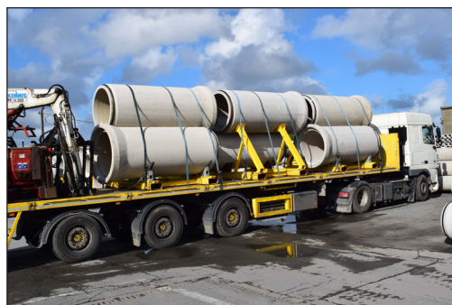
Figuur 2.1 – Per stuk geleverde betonbuizen (Bron: Lithobeton)
