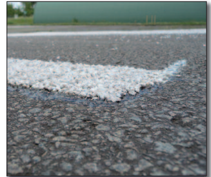
Figure 5 – Marquage final (configuration monocouche)
