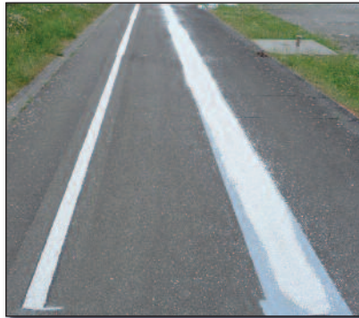
Figure 4 – Zone test sur enrobé: marquage une couche à gauche et deux couches (pose en cours) à droite
