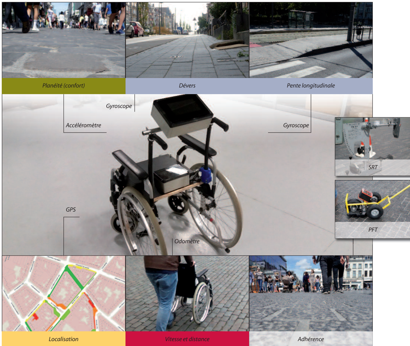
Figure 6 – Outil de mesure de la qualité d'usage des revêtements piétons en cours de développement (prototype 2)
