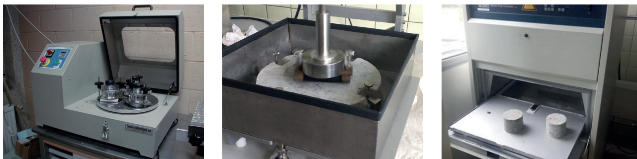
Figuur 1 – Verschillende verouderingsmethoden om de duurzaamheid van hydrofobe impregneermiddelen te bestuderen (van links naar rechts: PEI-test, afslijting volgens EN 12274-5 (NBN, 2018b), Q-Sun kamer)
