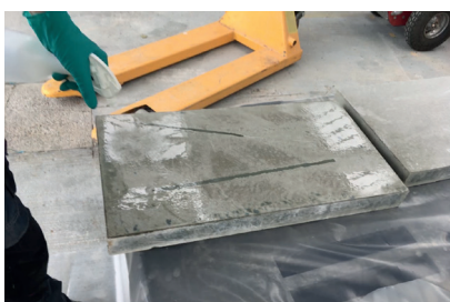
Figuur 2 – Toepassing van hydrofobe impregneermiddelen op testkubussen of betonnen proefplaten om hun eigenschappen en effectiviteit te beproeven
