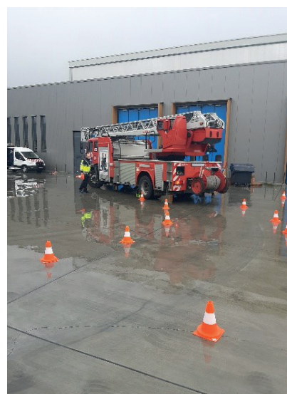
Figure 2 – Des tests de rotation ont été organisés par le CRR sur site privé (dépôt de la STIB à Haren) pour définir le rayon de rotation exact de l'autoéchelle utilisée par le SIAMU
