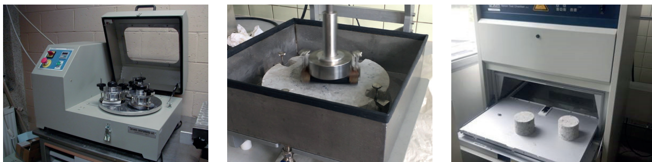
Figure 1 – Différentes méthodes de vieillissement pour étudier la durabilité des produits d'imprégnation hydrophobes (de gauche à droite: essai PEI, abrasion selon la norme EN 12274-5 (NBN, 2018b), chambre Q-Sun)
