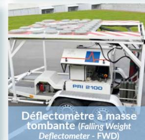
Déflectomètre à masse tombante (Falling Weight Deflectometer - FWD)
