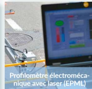
Profilomètre électromécanique avec laser (EPML)
