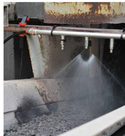
Ajout de produit régénérant aux AEB sur le tapis convoyeur à l'aide d'un dispositif de pulvérisation (source: CRR)
