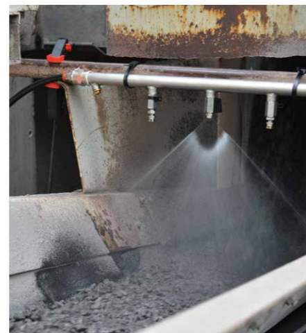
Toedienen van verjongingsmiddel aan AG op de aanvoerband door middel van een sproei-installatie (bron: OCW)
