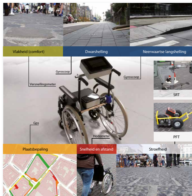
De door het OCW ontwikkelde meetstoel in combinatie met het gebruik van de PFT maakt het mogelijk de gebruikskwaliteit van voetgangersverhardingen te meten.
