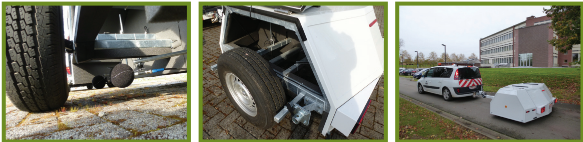
Figuur 16 – CPX-aanhangwagen (gesloten type) van het Opzoekingscentrum voor de Wegenbouw
