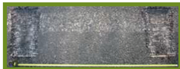
Figuur 9 – E3 (ruimte tussen 2 stroken: 1 m; breedte: 20 cm; diepte: 1,5 cm)
