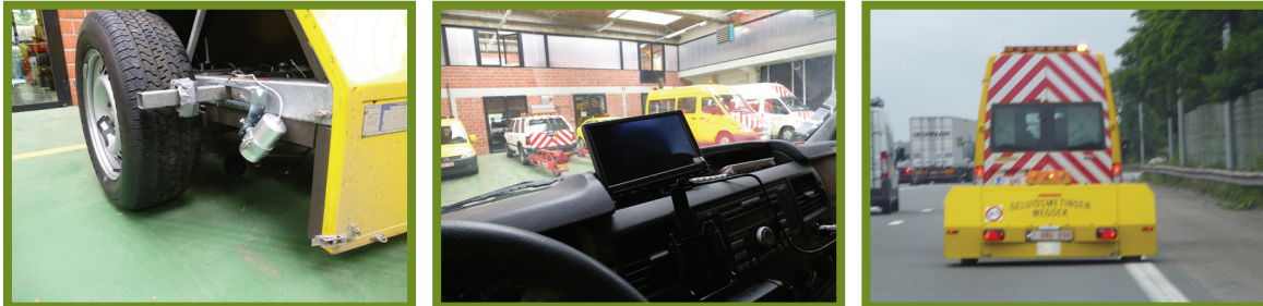
Figuur 17 – Een aangepaste CPX-aanhangwagen om reliëfmarkeringen te meten (links en midden) en de uitvoering van de metingen (rechts)
