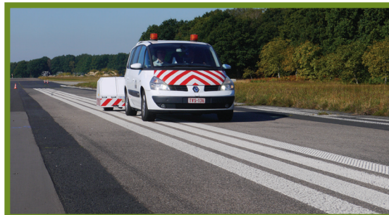
Figuur 18 – Metingen met de CPX-aanhangwagen van het OCW op de testbaan van Geilenkirchen
