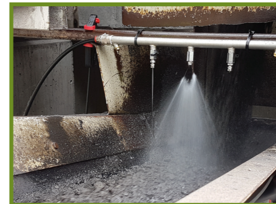
Figure 4 – Ajout de produit régénérant aux AEB sur le tapis convoyeur à l'aide d'un dispositif de pulvérisation (source: CRR [21])
