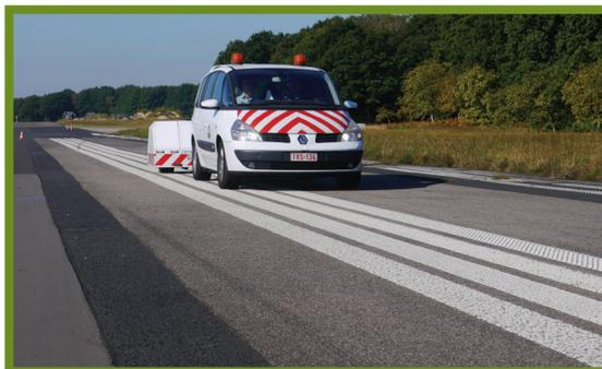
Figure 18 – La remorque CPX du CRR effectuant des mesures sur les marquages routiers de la zone d'essai de Geilenkirchen
