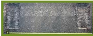
**Figure 9** – E3 (pas entre 2 bandes: 1 m; largeur: 20 cm; profondeur: 1,5 cm)
