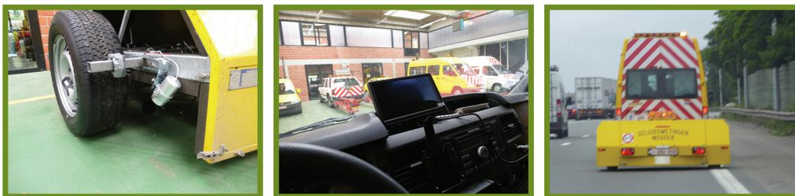
**Figure 17** – Une remorque CPX modifiée pour mesurer les marquages en relief (à gauche et au milieu) et réalisation des mesures (à droite)
