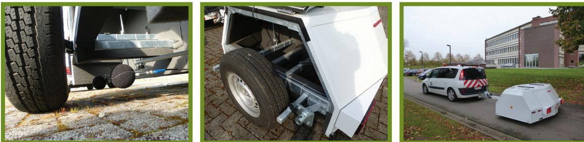
**Figure 16** – Remorque CPX (type fermé) du Centre de recherches routières
