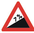
A5 Montée à forte inclinaison
