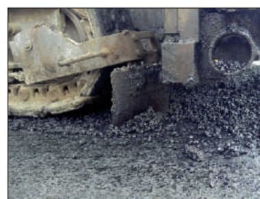
Figure 3.20 – Chasse-pierres monté devant les chenilles
