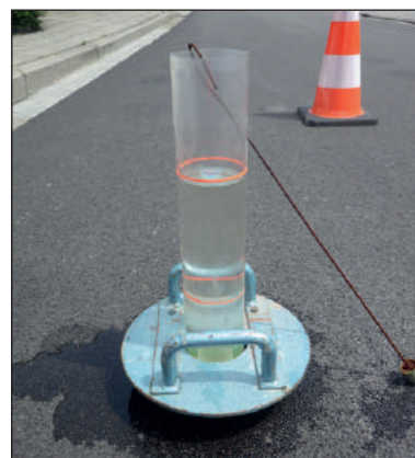
Figure 5.6 – Mesure du pouvoir drainant
