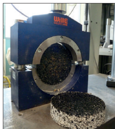
Figure 5.7 – Illustration de l'appareillage de cisaillement direct
