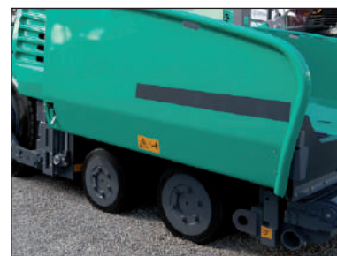
Figure 1.24 – Finisseur sur pneus
