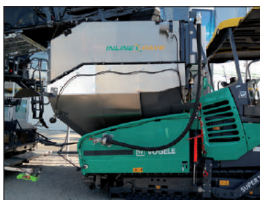
Figure 1.55 – Trémie supplémentaire sur le finisseur
