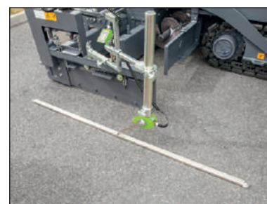
Figure 1.49 – Patin d'1 m avec senseur mécanique
