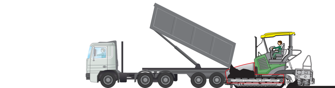
Figure 3.17 – Le finisseur pousse le camion durant le déchargement
