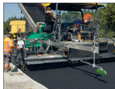
Figure 1.51 – Skis intégrateurs avec capteurs sans contact
