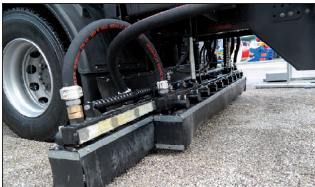
Figure 1.15 – Rampe de répandage
