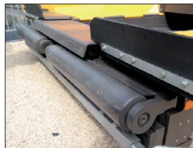
Figure 3.14 – Détail des rouleaux de poussage
