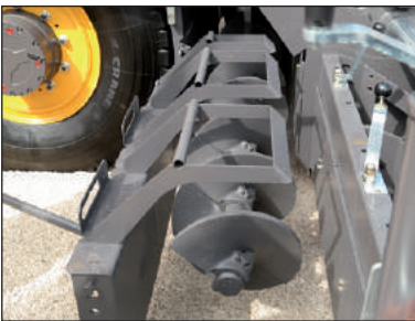
Figure 1.31 – Tôles limitatrices (à gauche de la vis de répartition) et prédéfecteur (à droite)
