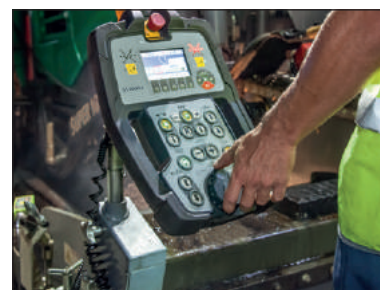
Figure 1.43 – Console de commande pour l'opérateur
