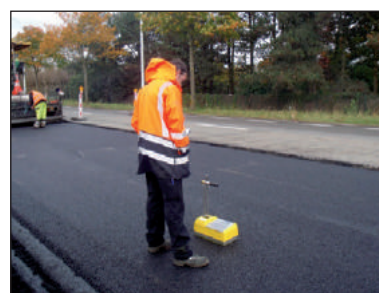
Figure 5.5 – Mesure de la densité au gammadensimètre
