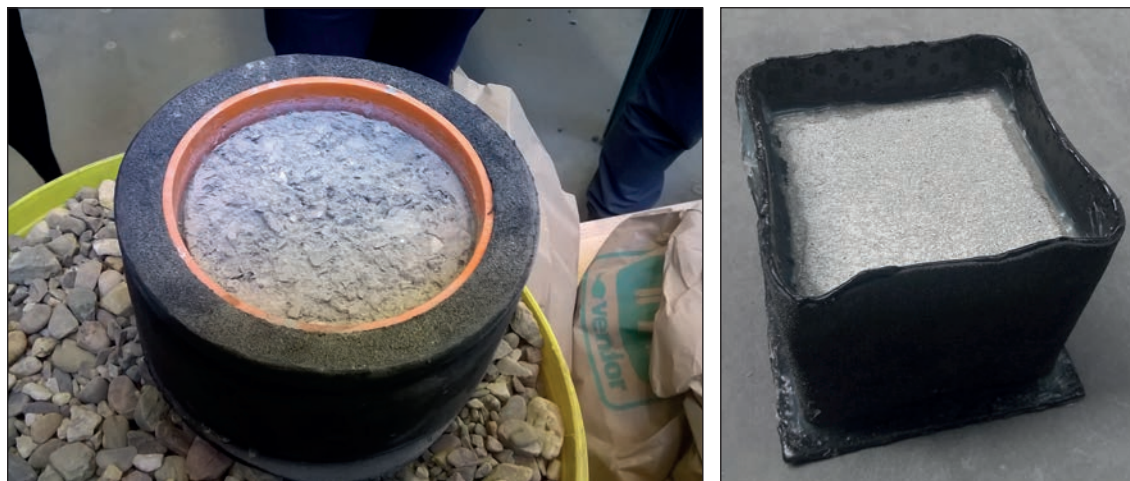
Figuur 6.3 – Proefstukken ter bepaling van de vorst-dooibestandheid in aanwezigheid van dooizouten volgens Bijlage D van NBN EN 1339
