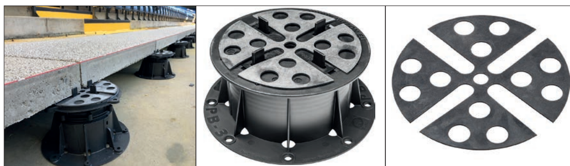
Figuur 4.17 – Hoogteregeling van de tegel dragers door schroeven en gebruik van vulstukjes
