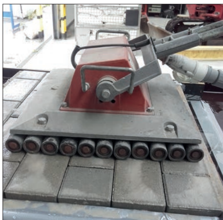
Figuur 4.4 – Ultrasoon toestel met rolletjes voor verdichting van de straatlaag bij klassieke (kleinere) tegels
