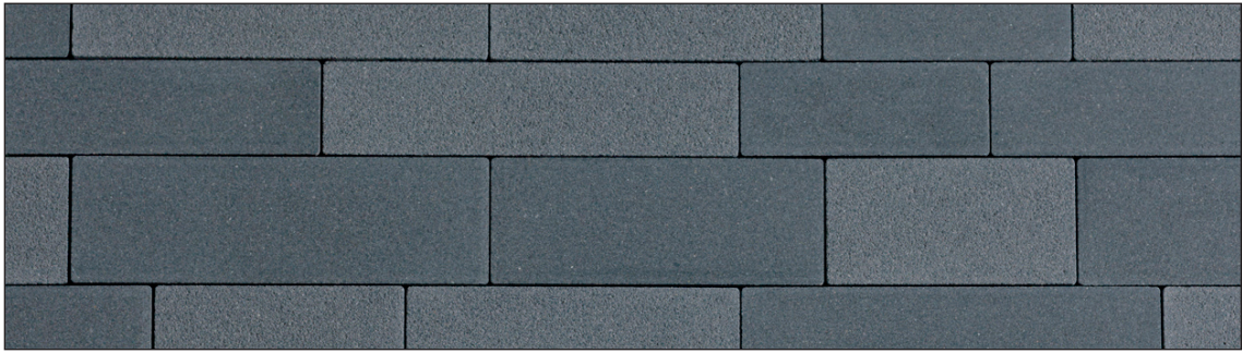
Figuur 5.12 – Voorbeeld van geslepen en gekogelstraalde afwerking: donkere = geslepen, lichtere = geslepen en nadien gekogelstraald (zelfde beton!)
