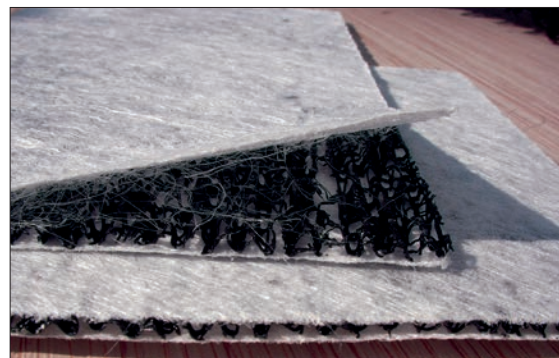
Figuur 7.8 – Voorbeelden van toepassing van een beschermingslaag bestaande uit een combinatie van drainerende noppenfolie en filterdoek
