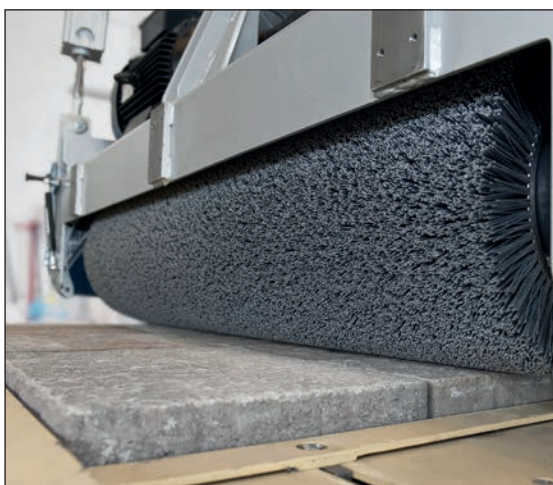
Figuur 5.18 – Curlen van het betonoppervlak
