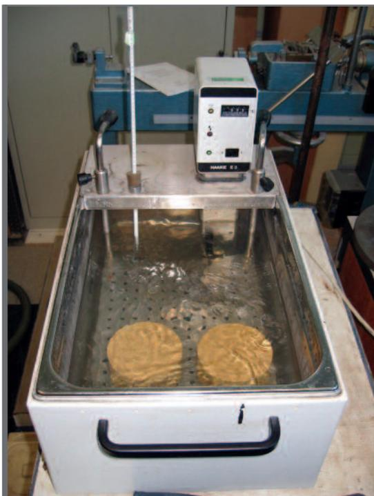
Figure 1.15 Conditionnement accéléré d'éprouvettes bitumineuses à 40 °C pendant 72 h
