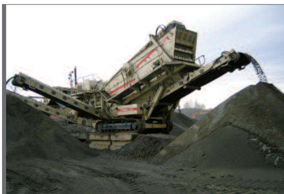
Figure 7.1 Centrale mobile de concassage et de criblage pour le recyclage en granulats du béton d'une route existante
