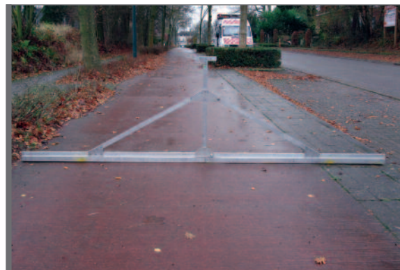
Figure 5.2 Mesures des irrégularités à la règle de 3 m
