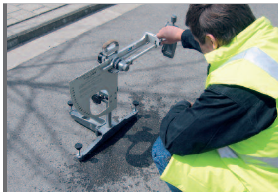
Figure 5.4 Mesure de la rugosité à l'aide du pendule SRT
