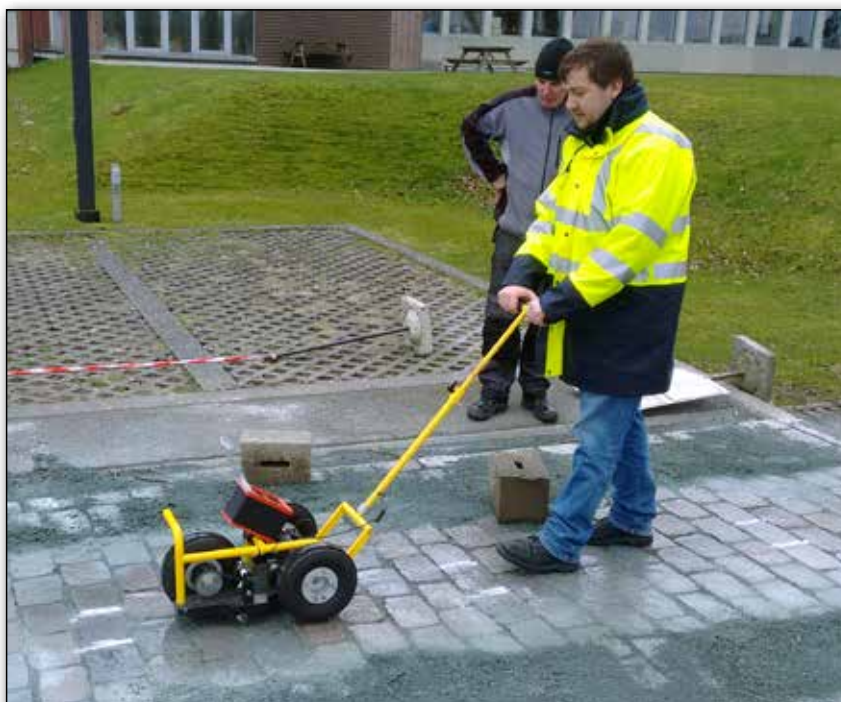
Figuur 7 – Metingen met het PFT-toestel van het OCW op proefvakken met natuursteenbestrating in Sterrebeek, ter bepaling van slipweerstand
