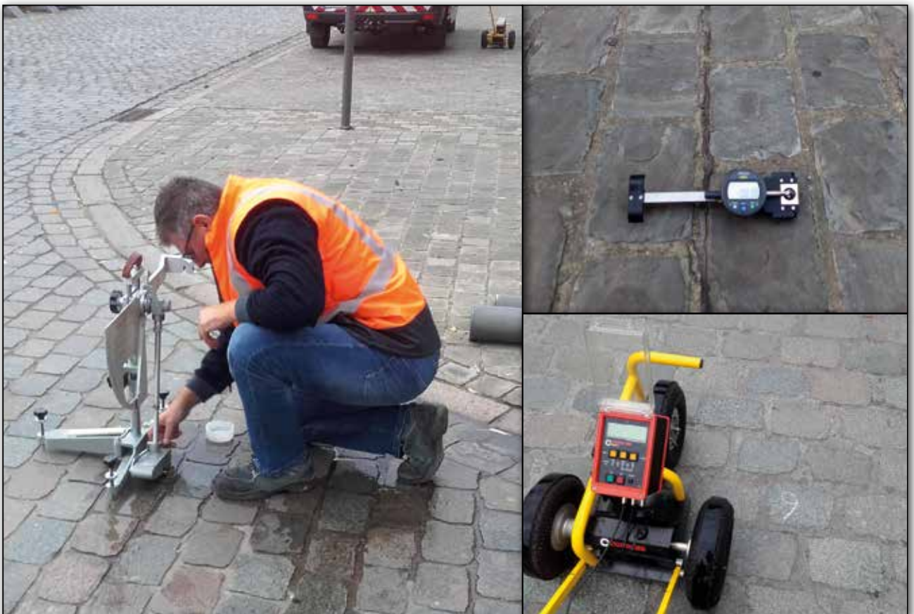
Figuur 9 – Validatie van prestatie-eigenschappen voor natuursteenbestratingen in situ
