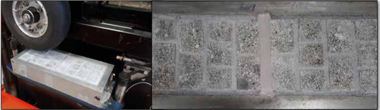
Figuur 8 – Uitvoering van de wielspoorproef op kleine maquettes van natuursteenbestrating (straatsteen + voegmortel)
