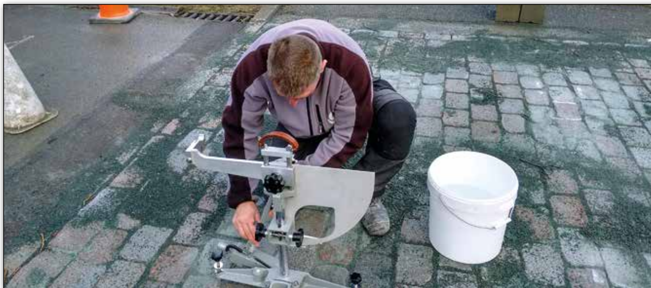
Figuur 2 – Uitvoering van metingen met de SRT-slinger op de proefvakken in Sterrebeek
