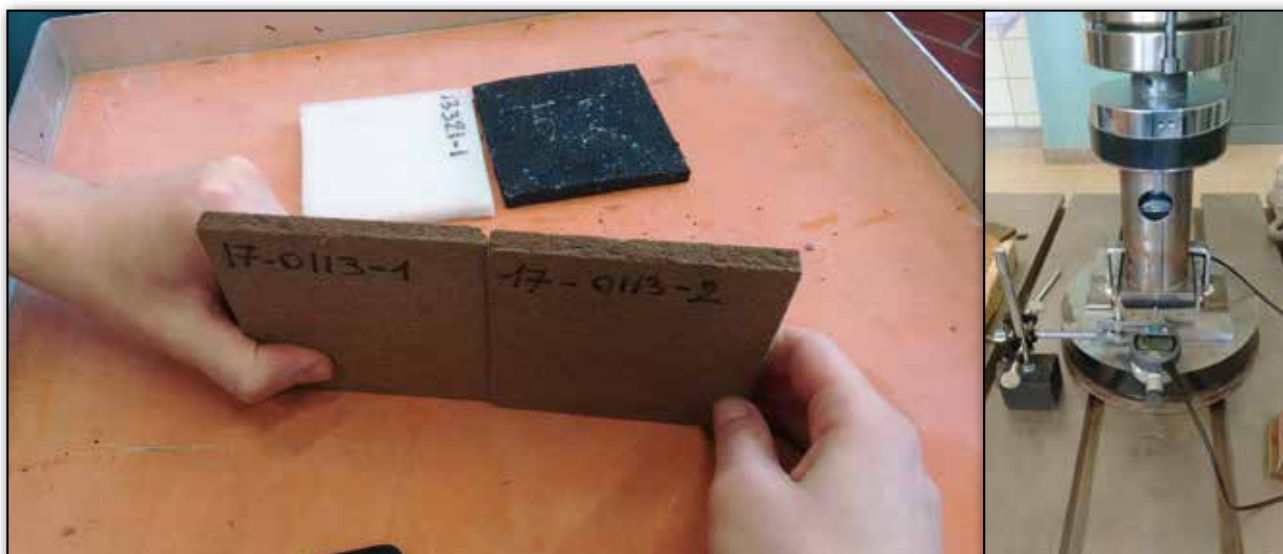
Figuur 6 – Voorbeeld van proeven ter bepaling van samendrukbaarheid en vervorming van voegplaten
