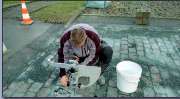
Figuur 5 – Controlemonsters en initiële metingen op de proefvakken met natuursteen
