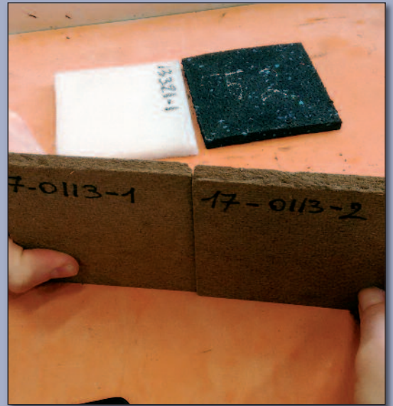
Figuur 2 – Voorbeeld van proeven ter bepaling van samendrukbaarheid en vervorming van voegplaten
