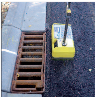
Figuur 2 – Ongunstig meetpunt 7 dicht bij een metalen straatkolk
