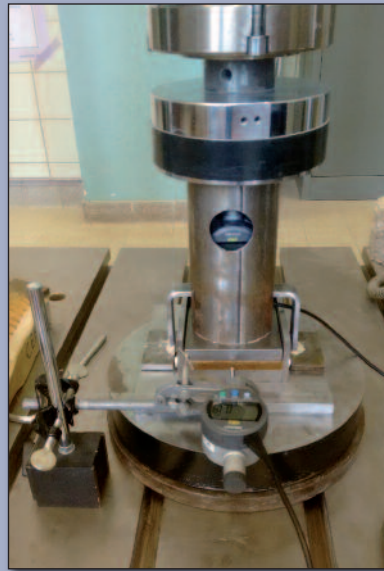
Figuur 2 – Voorbeeld van proeven ter bepaling van samendrukbaarheid en vervorming van voegplaten
