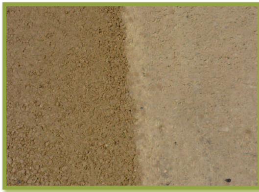
Figuur 11 – Tijdens het afkoelingsproces kan een kleurwijziging in het asfalt optreden (links: kleur bij 50 °C; rechts: kleur bij 35 °C)
