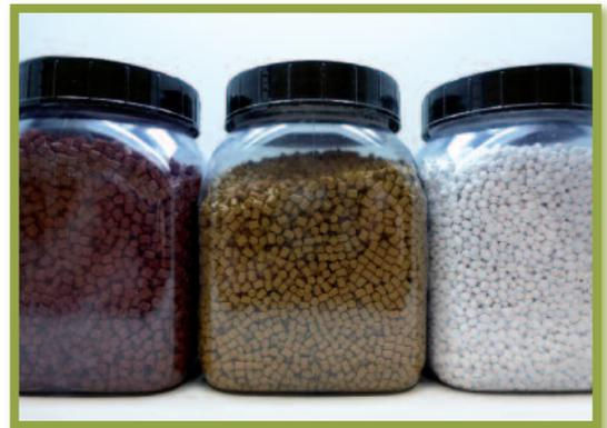
Figure 4 – Exemples de pigments minéraux (sous forme de granules enrobées de polymère) utilisables pour la fabrication d'enrobés bitumineux colorés
