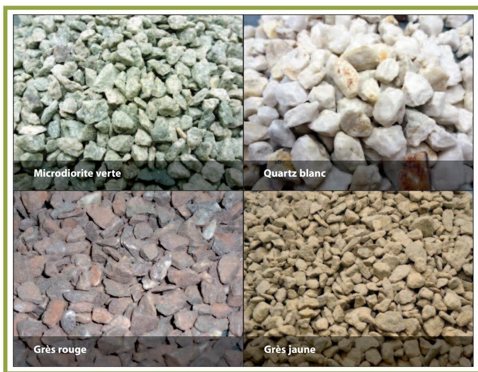
*Figure 1 – Exemples de granulats de couleur utilisables pour la fabrication d'enrobés bitumineux colorés*
