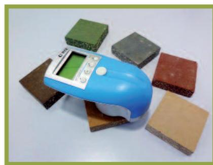
Figure 16 – Spectrophotomètre
