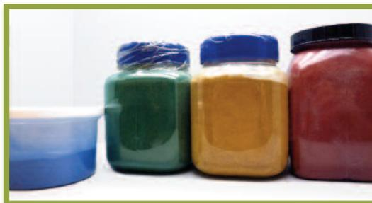
Figure 3 – Exemples de pigments minéraux (sous forme de poudre) utilisables pour la fabrication d'enrobés bitumineux colorés
