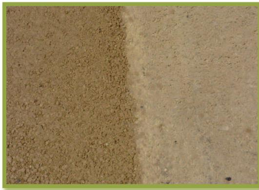
**Figure 11** – Changement de teinte de l'enrobé durant son refroidissement (à gauche: 50°C; à droite: 35°C)
