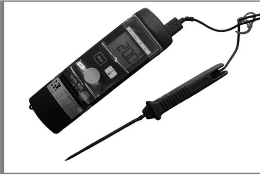
**Photo A.1.1** Sonde de température Cuivre-Constantan
