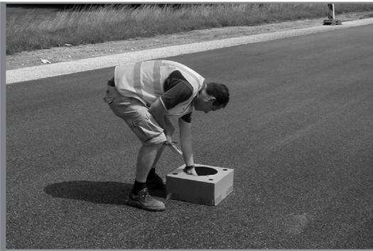
**Photo A.1.3** Mesure de la température au centre de la bande d'enrobé bitumineux
