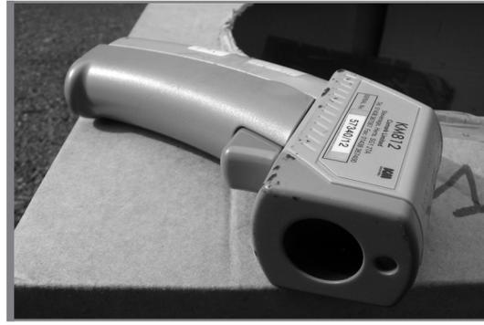
**Photo A.1.2** Thermomètre infrarouge
