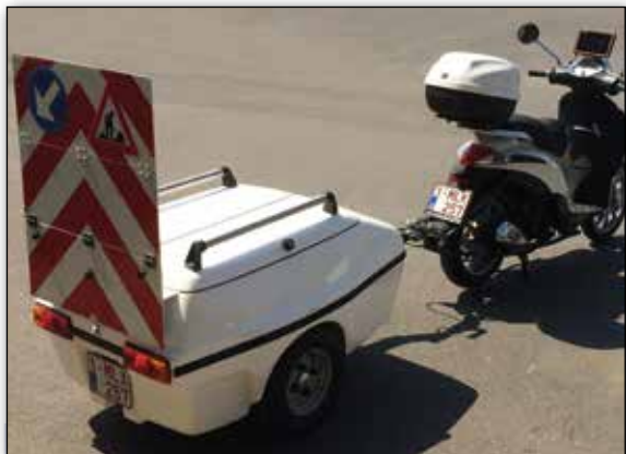
Figure 1 – Profilomètre pour pistes cyclables (FPP) du CRR pour le contrôle de l'uni longitudinal des pistes cyclables
