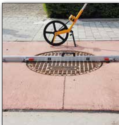
Figure 7 – La présence de plaques d'égout dans la piste cyclable entraîne souvent un pic dans les mesures d'uni
