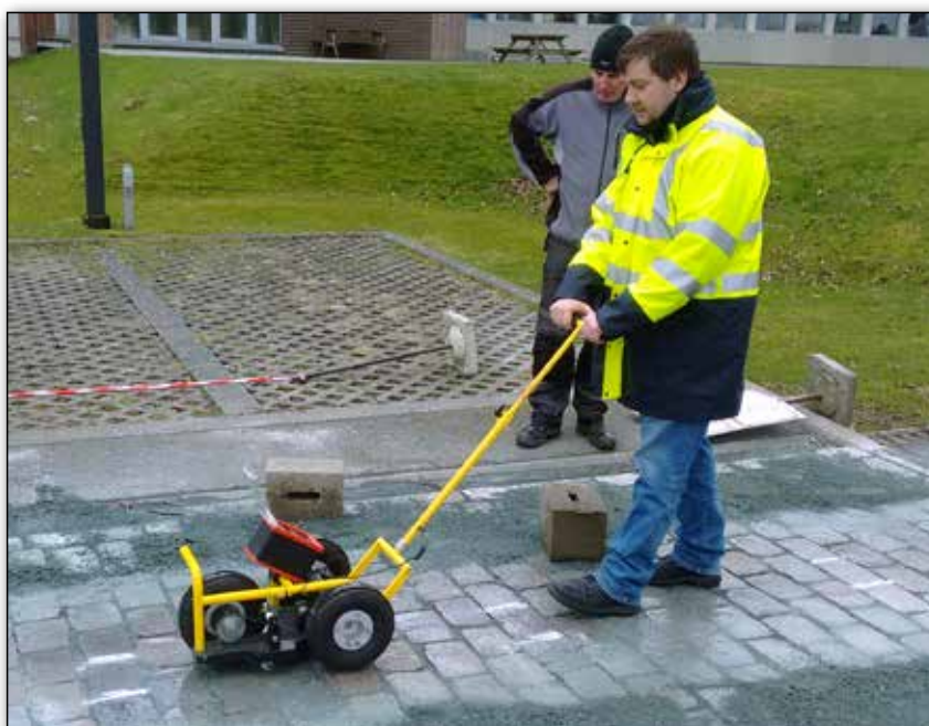
Figure 7 – Mesures à l'aide de l'appareil PFT du CRR sur les planches expérimentales en pavages de pierre naturelle à Sterrebeek, pour la détermination de la résistance à la glissance
