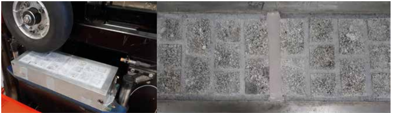
Figure 8 – Réalisation de l'essai d'ornièrage sur de petites maquettes de pavages en pierre naturelle (pavé + mortier de jointoiment)
