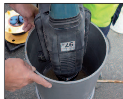
Figure 4 – Essai de perméabilité en colonnes: schéma global et compactage des matériaux
