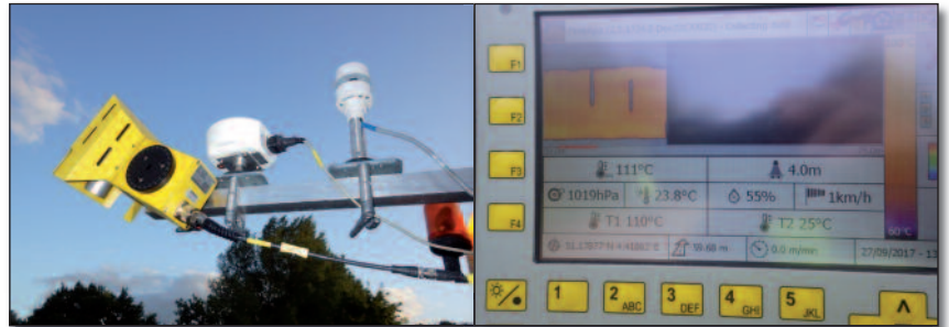
Figure 5 – Scanner IR en ligne avec module GPS et station météorologique (à gauche) et unité de traitement (à droite)
