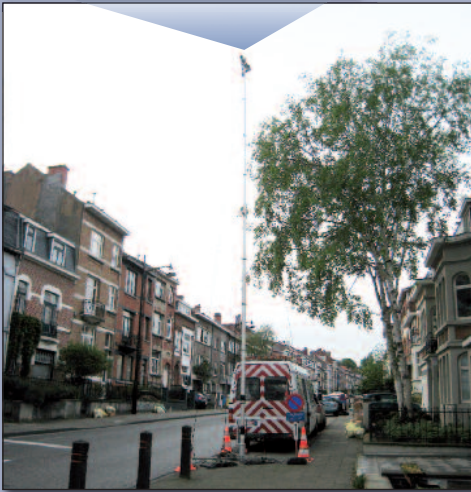
Figure 1 – Aperçu de la caméra (en haut) et du dispositif sur le mât télescopique sur le site test (en bas)
