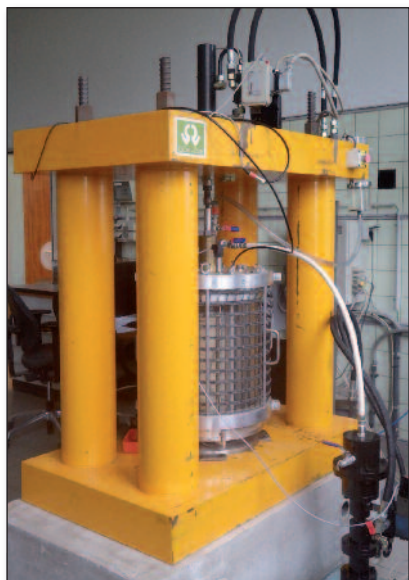
Figure 3 – L'essai triaxial cyclique permet de simuler les contraintes subies par les matériaux de sous-fondation lors du passage de véhicules
