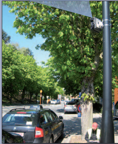
Figure 2 – Radar Doppler pour les mesures de vitesse
