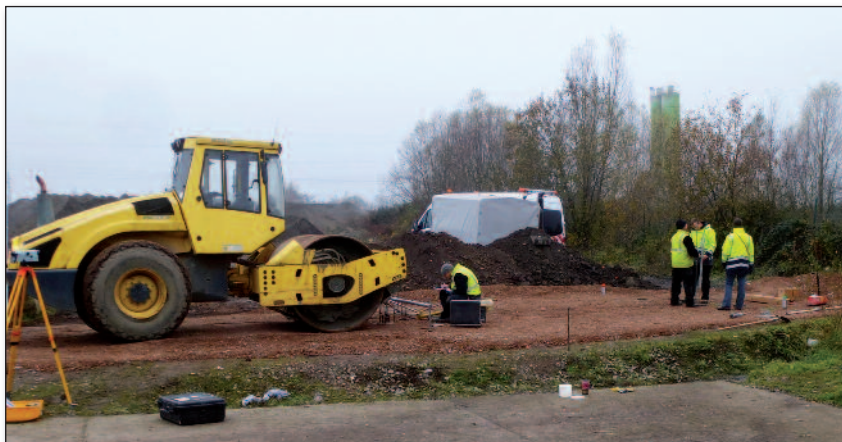
Figure 1 – Une première planche d'essais a été mise en œuvre pour observer in situ le comportement de granulats recyclés mixtes soumis à des cycles naturels de gel-dégel durant deux périodes hivernales
