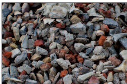
Figure 2 – Les granulats recyclés mixtes peuvent contenir jusqu'à 50 % de déchets de maçonnerie
