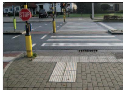
**Figure 3** – La présence d'un avaloir dans la traversée piétonne constitue un obstacle pour l'usager
