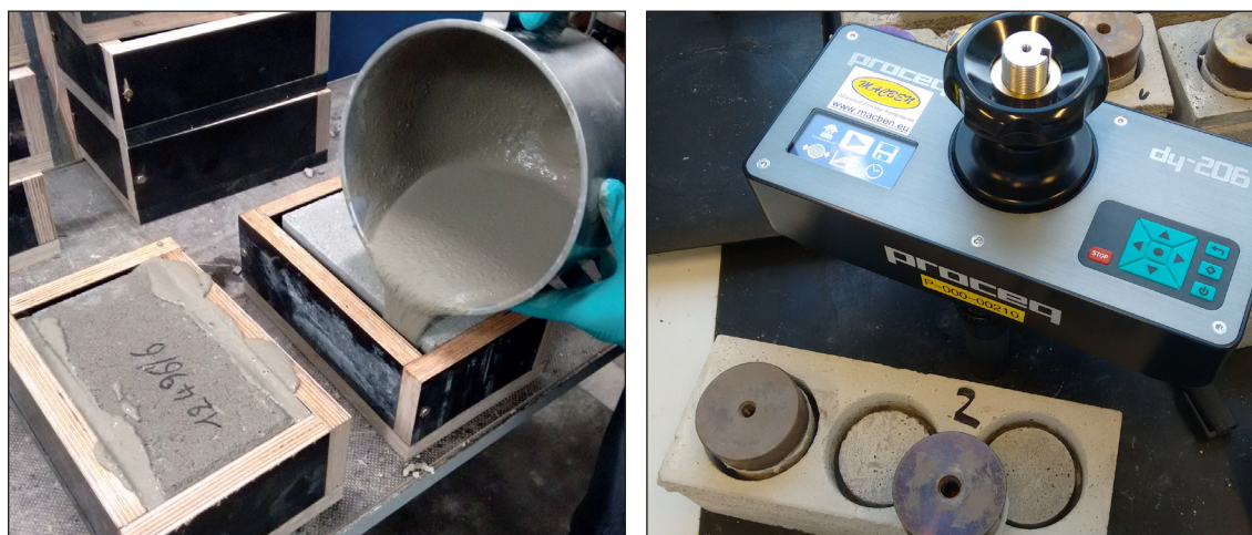
Figuur 20 – Proeven ter bepaling van de directe hechtsterkte tussen straatsteen en voegmortel volgens NBN EN 1542
