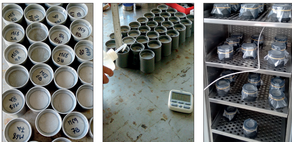
Figuur 10 – Proef ter bepaling van weerstand tegen vorst-dooicycli in aanwezigheid van dooizouten, aangepast voor cementgebonden voegmortels
